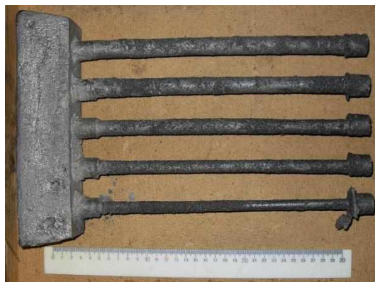
Рис. 1. Вид образца пробы горячие трещины
