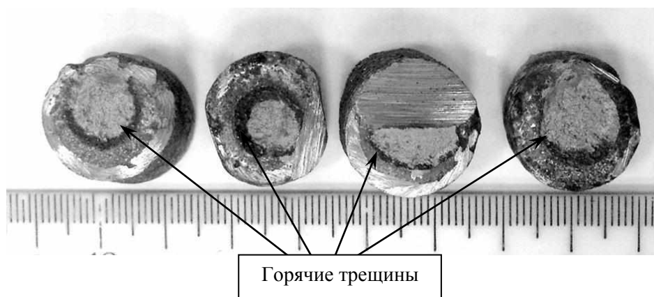
Рис. 5. Горячие трещины в образцах диаметром 10 и 12 мм из стали марки 12X18H12M3ТЛ
