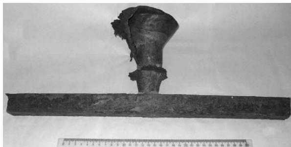
Рис. 2. Образец пробы на линейную усадку
