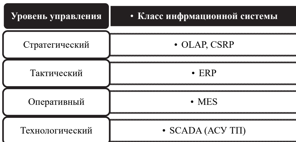
Рис. 2. Иерархическая структура управления предприятием
