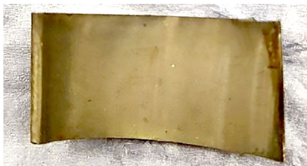
Рис. 8. Образец, обработанный на мощности 1500 Вт. Fig. 8. Test piece processed at 1500 W.
