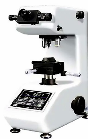
Рис. 4. Микротвердомер Future Tech FM-31. Fig. 4. Microhardness tester (Future Tech FM-31).
