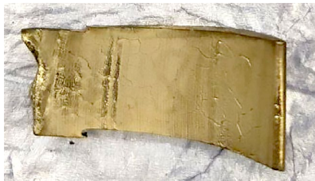
Рис. 7. Образец с трещинами и проплавлениями.
