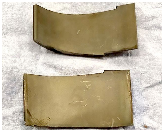
Рис. 9. Образцы с неснятым термобарьерным покрытием. Fig. 9. Test pieces with the thermal barrier coating not removed.
